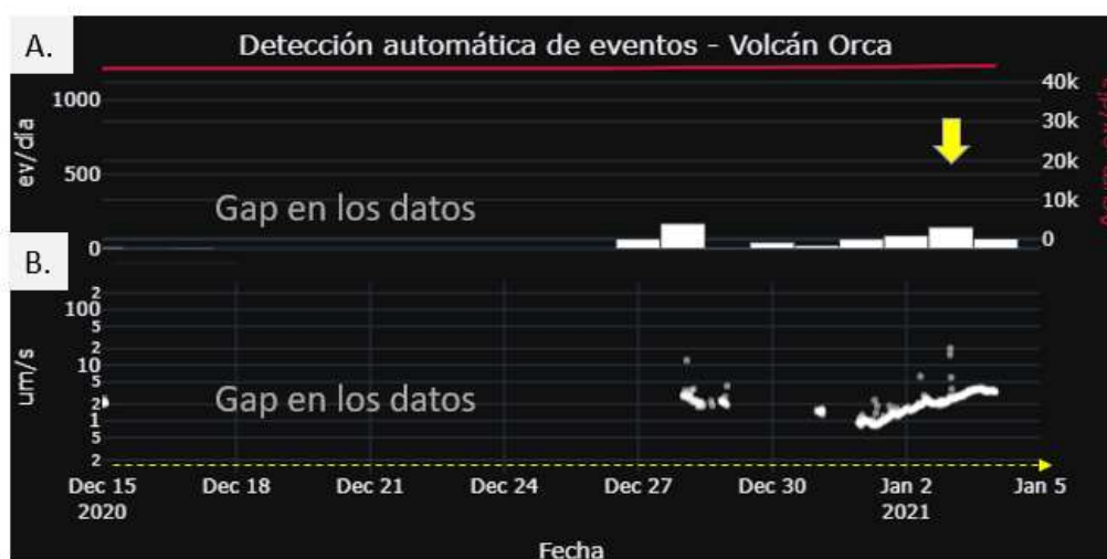
Fig. 1. Detección automática de sismicidad en estación JUBA, durante finales de diciembre de 2020 y principios de enero de 2021. En la parte superior (A) se indican los eventos por día (barras blancas) y número de sismicidad acumulada (línea continua roja). En la parte inferior (B.) se muestra la energía de la señal continua a partir del Rudecindo Ortega #03850, Temuco - CHILE - Fono:(56-2) 249 63300 - Página Web: www.sernageomin.cl
